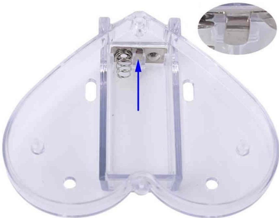
17. Drücke die beiden kleinen Batteriekontakte ins Gehäuse. Achte auf die korrekte Position und Ausrichtung.
