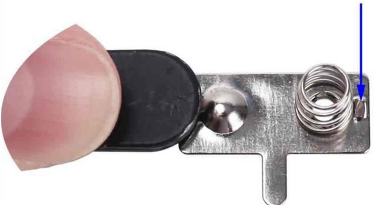
15. Drücke den breiten Batteriekontakt ins Acrylgehäuse
