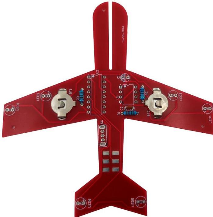
4. Rote LEDs auf LED1,LED4 und grüne LEDs auf LED2, LED3 löten. Die LEDs testweise nach vorne Biegen vor dem Festlöten.
