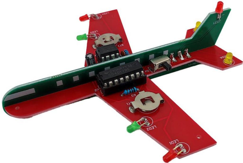
12. Batterien mit + nach unten einlegen und Schalter betätigen
