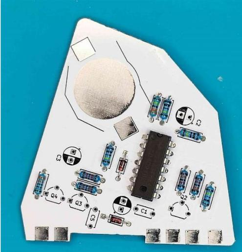
8. BC556 Transistor auf Q2 anlöten (Achtung: Verwechslungsgefahr mit den BC546)
