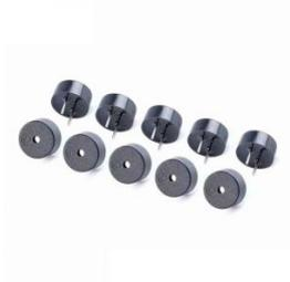
Diese Mini Piezo Summer vom Typ 9042 eignen sich hervorragend für den Einsatz in Elektronik- und DIY-Projekten. Sie arbeiten im passiven Modus mit einem Widerstand von 16 Ohm und einer Wechselfspannung von 3 bis 3,3 Volt. Dank ihrer kompakten Bauform von nur 9 x 4,2 mm lassen sich die Summer problemlos in beengte Schaltungen integrieren.
