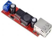
Der **LM2596 DC-DC Step-Down Spannungswandler mit Dual USB-Ausgang** ist ein kompakter und leistungsstarker **Abwärtsregler**, der Eingangsspannungen von **6V bis 40V** zuverlässig auf **5V** herunterregelt – ideal zur Stromversorgung von USB-Geräten wie Smartphones, Mikrocontrollern, Raspberry Pi, Arduino oder Powerbanks.
