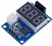
Die HC-SR04 Distanztester Steuerplatine mit dem leistungsstarken STM8S103 Mikroprozessor ist die ideale Ergänzung für den HC-SR04 Ultraschallsensor. Mit ihrem digitalen Display und der Fähigkeit, Daten über die serielle Schnittstelle auszugeben, bietet diese Steuerplatine präzise und benutzerfreundliche Distanzmessungen im Bereich von 3 cm bis 400 cm.
