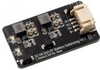
Das BMS 3S Active Balancer Board ist ein Batteriemanagementsystem, das für die Verwendung mit Lithium-Eisenphosphat (Lifepo4), Lithium-Polymer (Lipo) und Lithium-Ionen-Batterien ausgelegt ist. Es ist ein Modul, das dazu dient, den Ladestand der Batterien auszugleichen und sicherzustellen, dass jeder Akku in der Batterie gleichmäßig geladen wird.
