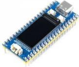
RP2040-LCD-0.96 ist ein kostengünstiges, leistungsstarkes Pico-ähnliches MCU-Board mit flexiblen digitalen Schnittstellen. Es enthält den RP2040-Mikrocontroller-Chip des Raspberry Pi, der dem des Raspberry Pi Pico entspricht. Für die Softwareentwicklung steht entweder das C/C++ SDK von Raspberry Pi oder MicroPython zur Verfügung, was den Einstieg und die Integration in Endprodukte erleichtert.
