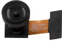
Dieses OV2640 Kameramodul eignet sich perfekt zum Anschluss an IoT Mikrocontrollern wie z. B. SIPEED, ESP-EYE, ESP-32CAM, STM32 (STM32F4 F7). Es besitzt ein 120° Weitwinkelobjektiv für ein besonders großes Sichtfeld und bietet alle Funktionen einer Ein-Chip-UXGA-Kamera und Bildprozessors.
