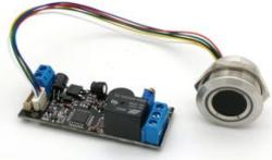
Robuster Fingerabdrucksensor mit RGB-Beleuchtung, hoher Auflösung und Erkennungsrate. Sehr einfacher Einbau mit 25mm Außendurchmesser. Durch die Relais-Steuerplatine K202 lässt sich der Sensor direkt anschließen und zum Öffnen eines elektronischen Türschlosses verwenden.
