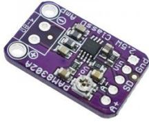
Dieser superkleine **Mono-Verstärker** ist überraschend leistungsstark - er kann bis zu 2,5 Watt an Lautsprecher mit einer Impedanz von 4-8 Ohm liefern. Im Inneren des Miniatur-Chips befindet sich ein **Class-D-Controller**, der mit 2,0V-5,5VDC betrieben werden kann.
