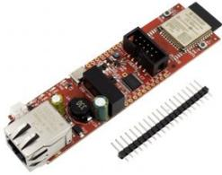
ESP32-PoE ist eine IoT WIFI/BLE/Ethernet-Entwicklungsplatine mit Power-Over-Ethernet-Funktion. Der Si3402-B-Chip ist IEEE 802.3-kompatibel, einschließlich der Unterstützung von PoE nach älteren Standards (Legacy). Das Board wird über das Ethernet-Kabel mit Strom versorgt und kann mit Sensoren und Aktoren erweitert werden. Perfekte Lösung für Internet-of-Things-Projekte.
